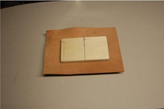
Anschliessend wird das Leder in der Form getrocknet. Die Dauer ist temperaturabhängig (bis zu 5 Tage).
