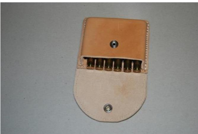
Zum Schluss wird ein Druckknopf angenäht.
