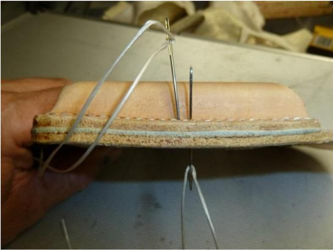
Nun werden Vorder- und Rückseite mittels zwei Nadeln und Zwirn zusammengenäht.
